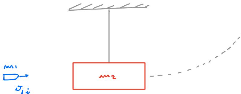
Medindo a altura que o bloco sobe, podemos calcular a velocidade da bola.
