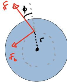
O torque será  $\tau = F_t r$ , onde  $r$  é a distância entre o ponto de aplicação da força e o eixo de rotação (nesse caso o centro do disco).
