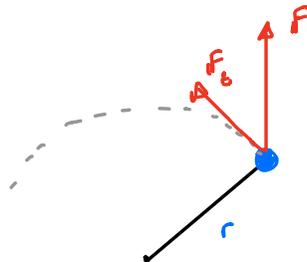
A força pode ser aplicada numa direção arbitrária. Mas como a barra é rígida, a única componente que vai importar é a tangencial. A componente normal é 100% compensada pela tensão na barra.
